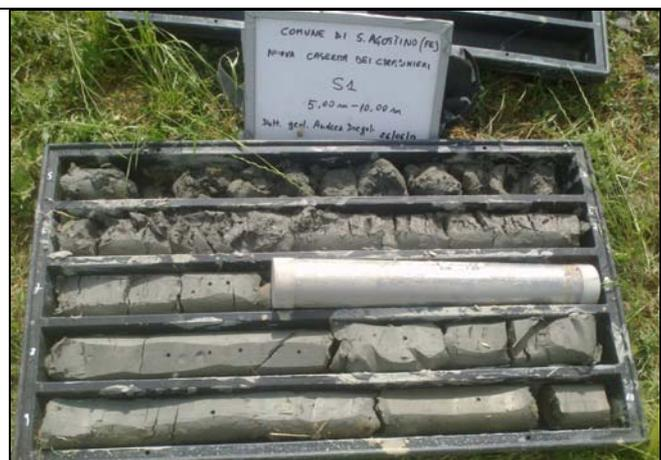
Figura 4.10 – Cassa catalogatrice S1 da 5,00 a 10,00 metri da p.c.
