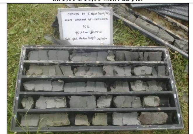
Figura 4.12 – Cassa catalogatrice S1 da 15,00 a 20,00 metri da p.c.
