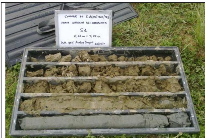
Figura 4.9 – Cassa catalogatrice S1 da 0,00 a 5,00 metri da p.c.
