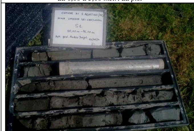
Figura 4.11 – Cassa catalogatrice S1 da 10,00 a 15,00 metri da p.c.
