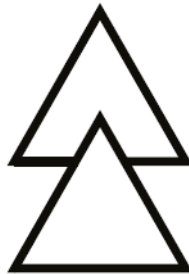
Figura 4.1: Simbolo del doppio triangolo per indicare l'idoneità del DPI come misura contro lo shock elettrico
