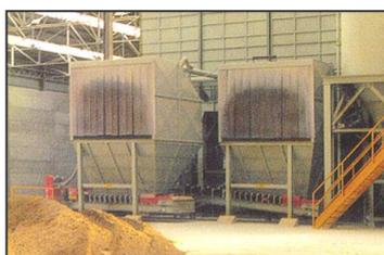
*Fig. A.1.1: esempio di tramoggia di carico senza rompizolle.*
