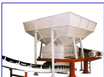
*Fig. A.1.2: esempio di tramoggia di carico con rompizolle.*
