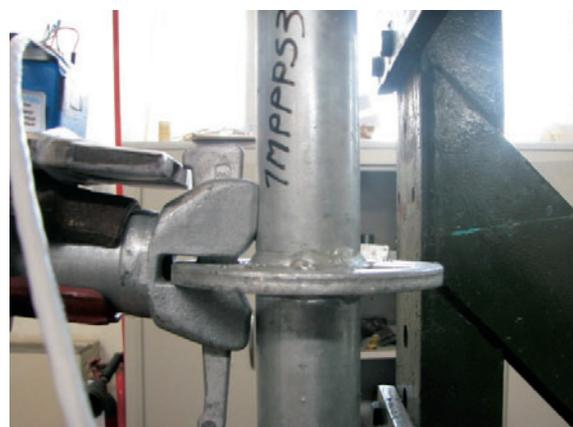
Figura 4.2.2.4-5: Evidente imbozzamento del montante
