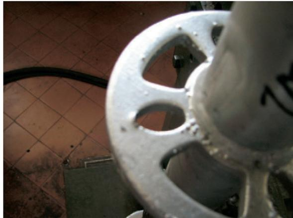
Figura 4.2.2.4-9: Fine prova - Deformazione permanente (ovalizzazione) del foro della rosetta
