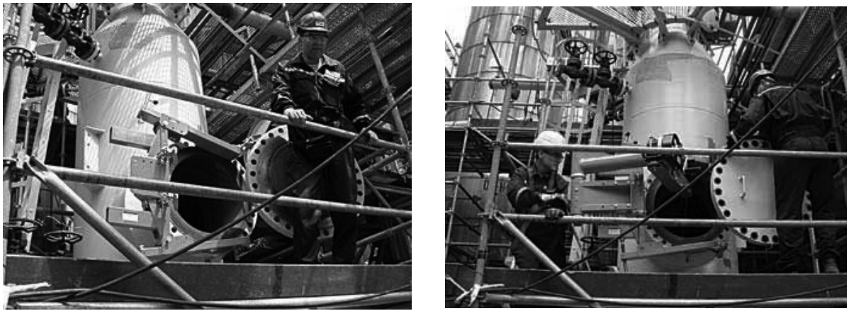
Figura 8. Ancoraggio mobile per il recupero persone a “braccio entrante”. Pensato per serbatoi e reattori.
