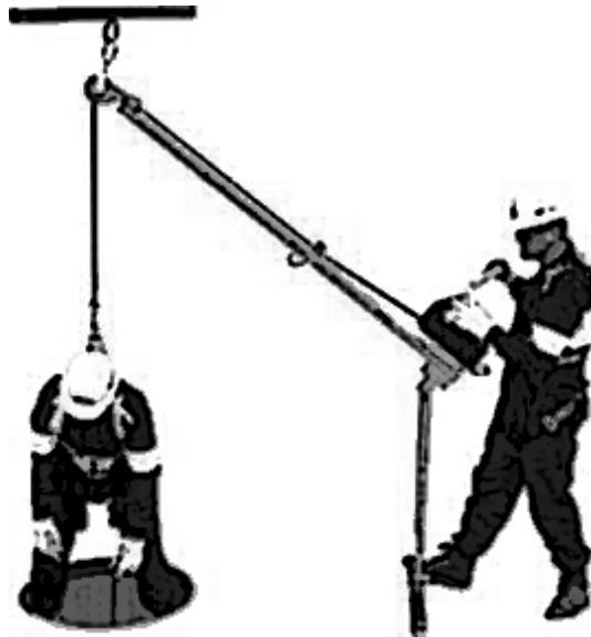
Figura 4. Ancoraggio mobile a cui fissare mezzi anticaduta o per il recupero persone.
