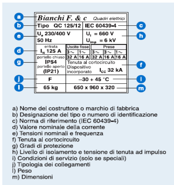
Figura 13.2 – Esempio di targa dei quadri ASC
