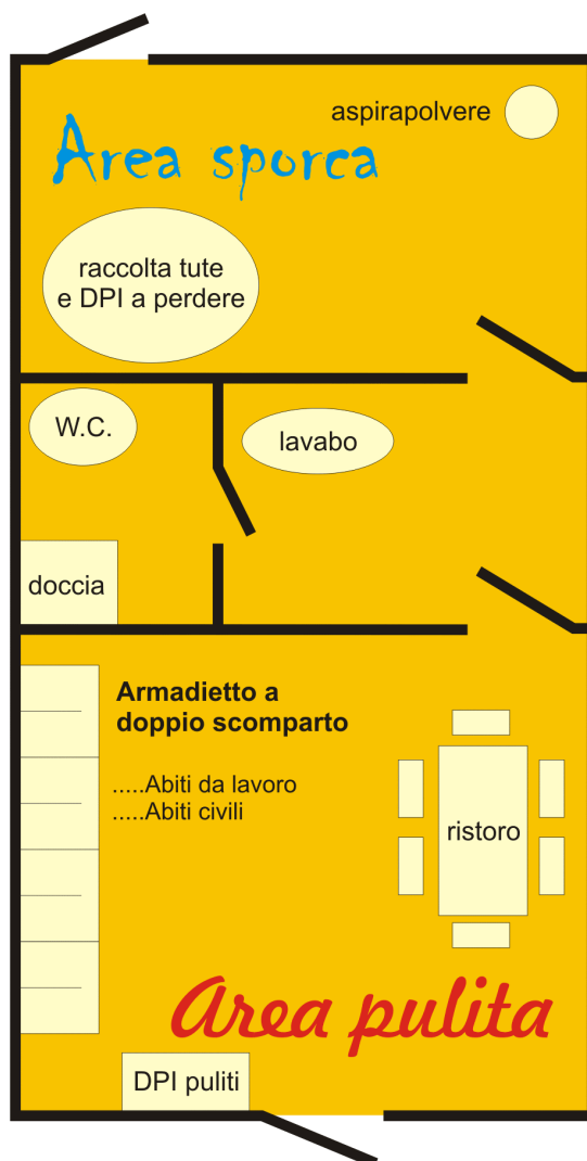
Figura 59 - Percorso Pulito-Sporco per gli operatori
