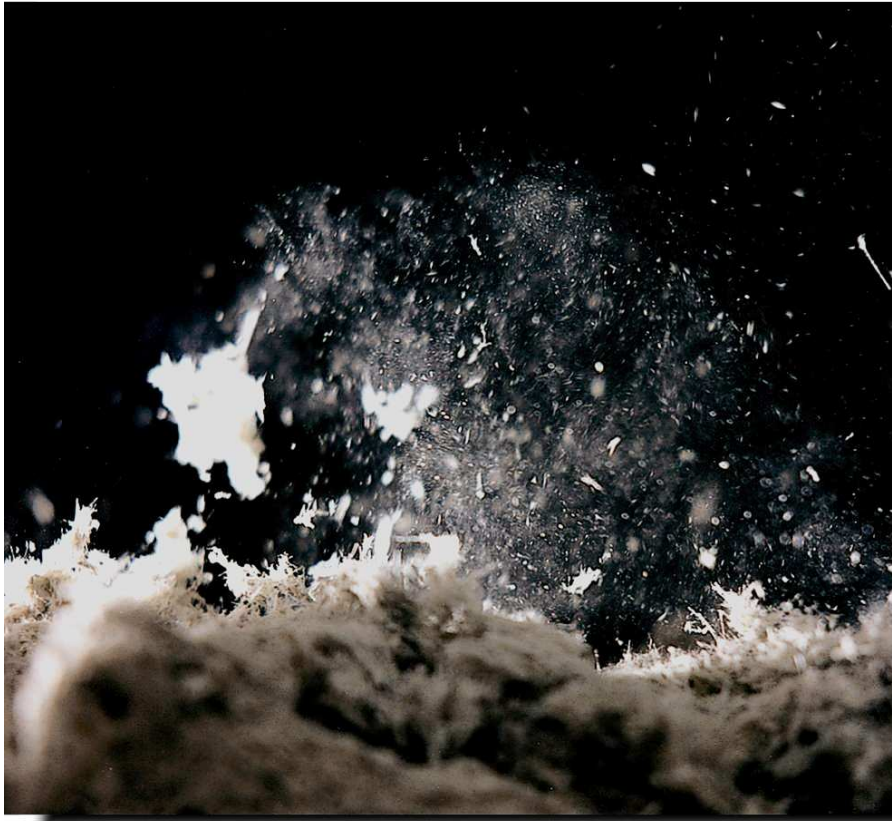
Figura 12 - Friabilità e rilascio fibre
